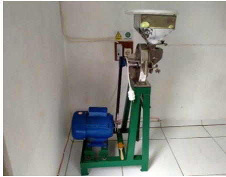
Gambar 9. Mesin penepung dan penggerak motor listriknya
