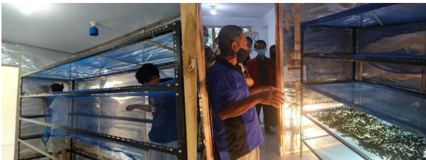
Gambar 5 . Pemasangan rak pengering dan pemanasan menggunakan lampu halogen
