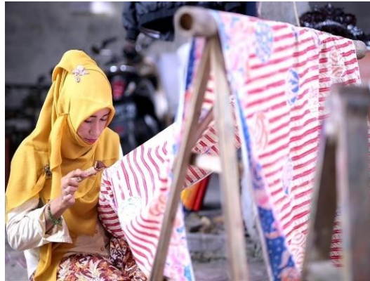
Gambar 5. Proses melukis dengan canting dan lilin pada produksi batik
