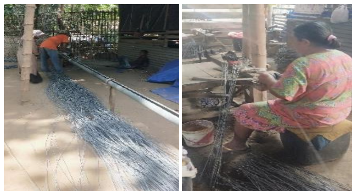
Gambar 2. Proses pelurusan kawat dan proses pemotongan
