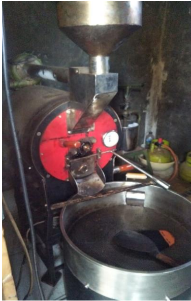
Gambar 3a. Revitalisasi mesin roasting di UKM Kopi Manunggal
