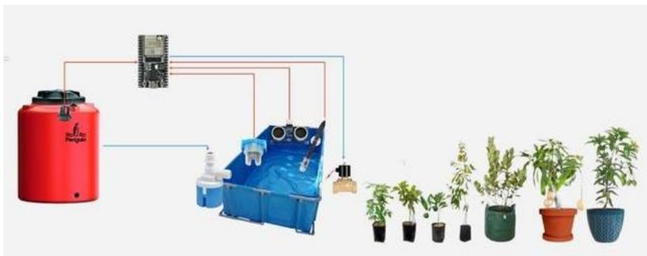
Gambar 4. Rangkaian pengontrol air kolam lele
