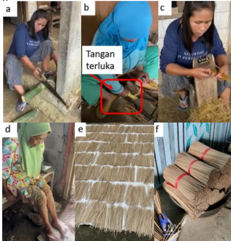
Gambar 1. Proses pembuatan tusuk sate dengan peralatan tradisional
