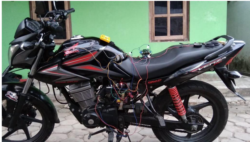
Gambar 2 . Instalasi ECU modifikasi pada Honda Verza 150 FI
